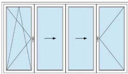
Одна поворотно-откидная, две сдвижных и одна поворотная створка
