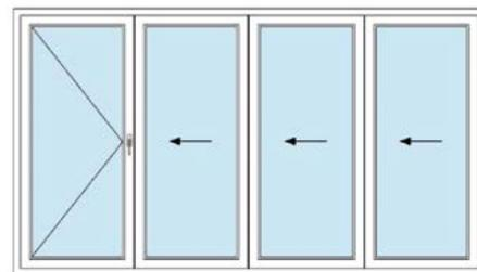
Одна поворотная и три сдвижных створки
