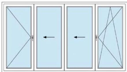
Одна поворотная, две сдвижных и одна поворотно-откидная створка
