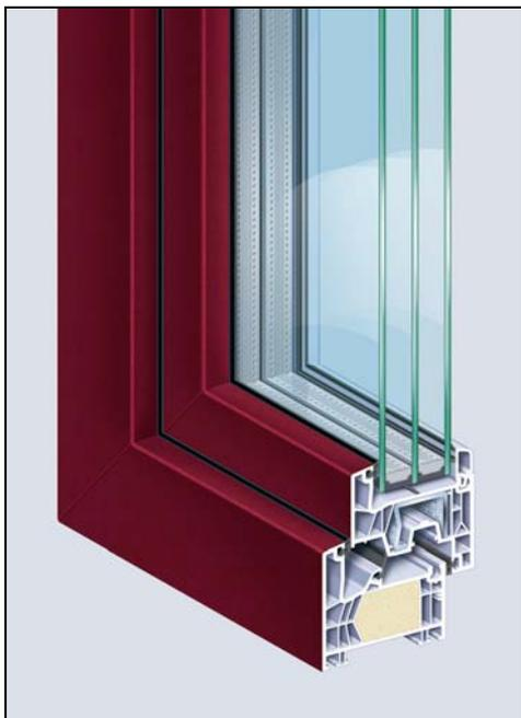
Mit werkseitig ausgeschäumtem Blindrahmen und stahlverstärktem Flügel bietet das „System 76“ Mitteldichtung eine Kombination, die die Passivhaus-Tauglichkeit gemäß ift-Richtlinie WA 15/2 erfüllt.
